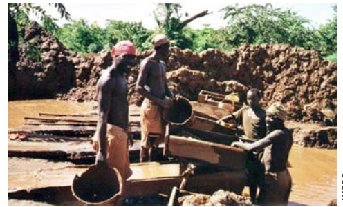
Concentration d'or au moyen de boîtes à écluses en Tanzanie
